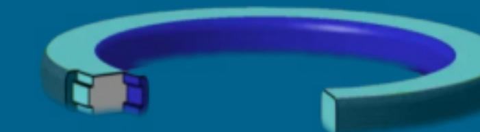
Для увеличения ресурса долота в шарошки устанавливается композитное уплотнение (CS). Уплотнение изготавливается из износостойкого композитного материала, способного эффективно работать при высоких оборотах.
