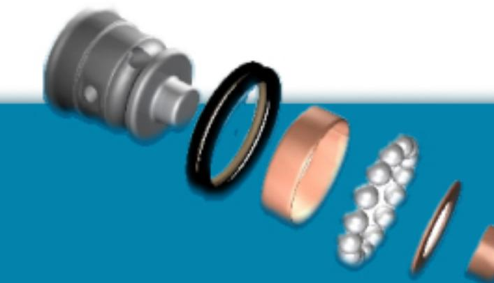
Втулки и шайбы покрываются слоем износостойкого сплава, а ответные поверхности корпуса шарошки – слоем серебра, что кратно увеличивает несущую способность и противозадирные свойства подшипника.
